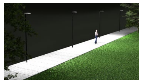
Oświetlenie progresywne. Asymetryczny układ optyczny do ciągów pieszych
